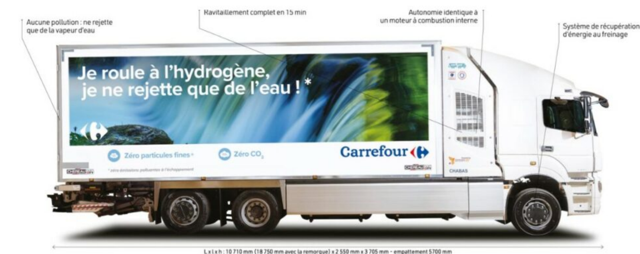
L x l x h : 10 710 mm (18 750 mm avec la remorque) x 2 550 mm x 3 705 mm - empattement 5700 mm
