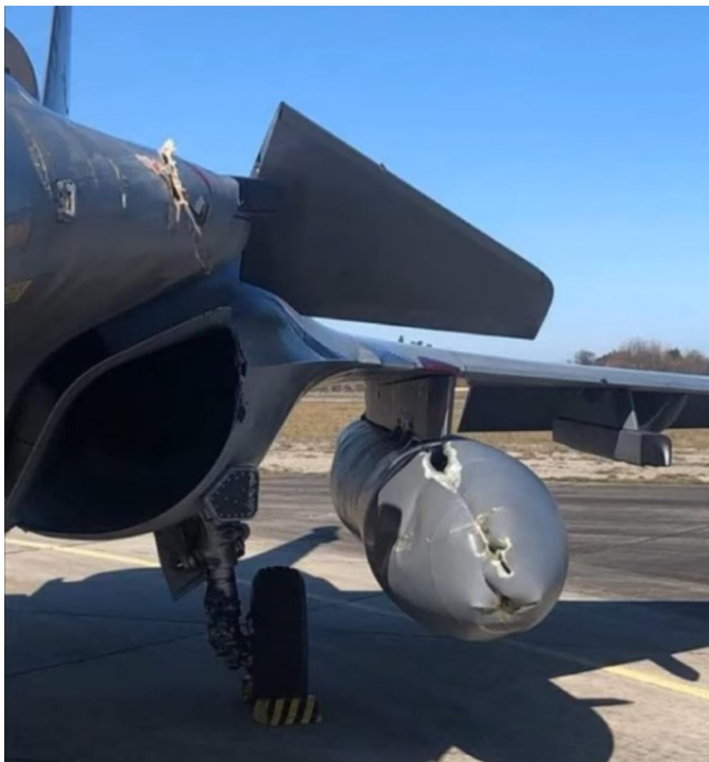
Le 17 février dernier, un avion Rafale B a sectionné trois câbles d'une ligne à moyenne tension lors de son passage durant un vol d'entraînement à très basse altitude (entre 80 et 150 mètres du sol) dans les environs du village du Castellet, dans les Alpes-de-Haute-Provence.
