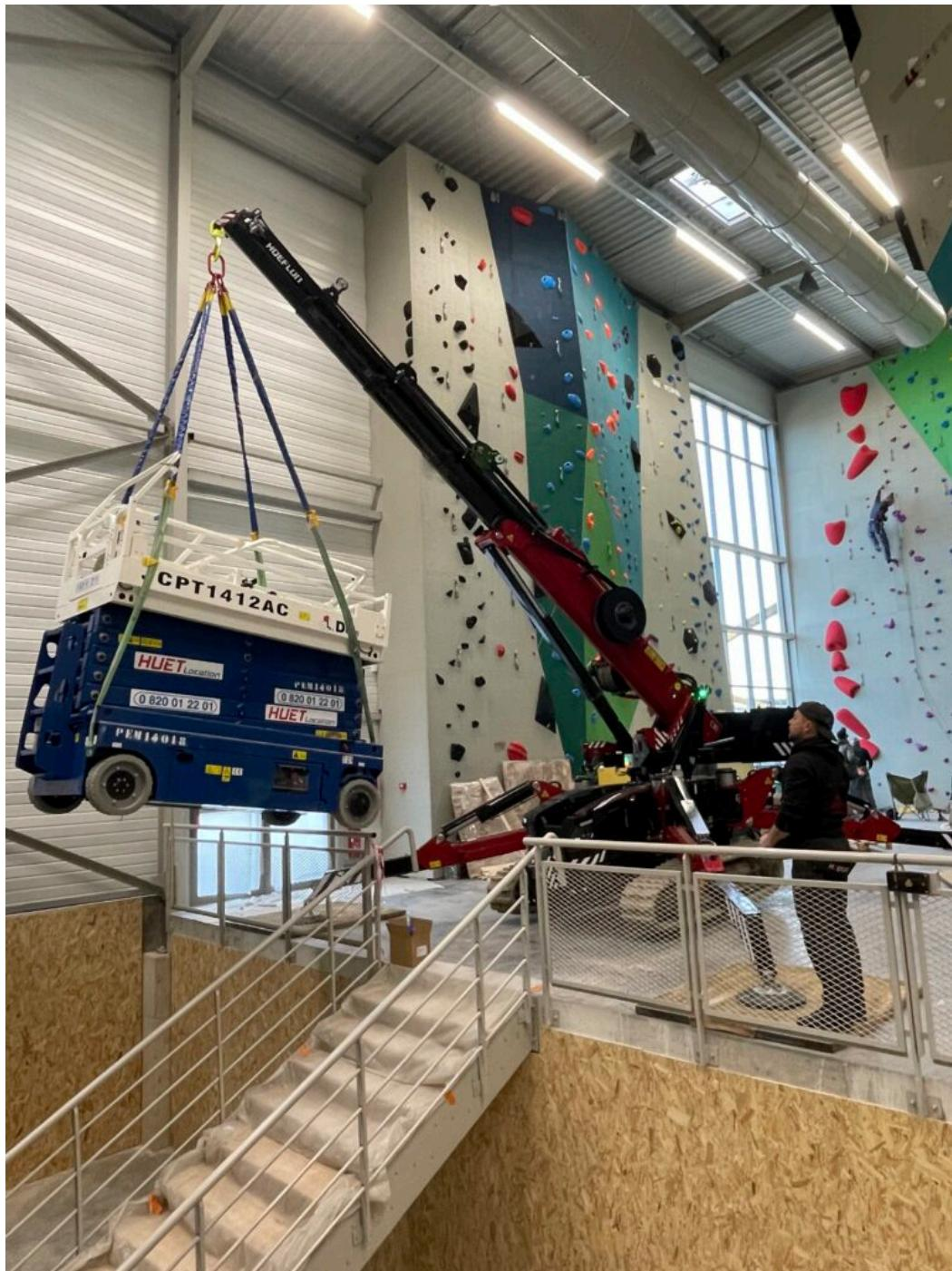
**Cette grue 'araignée' électrique rétractable est capable de sortir jusqu'à 5 tonnes de matériel de la fosse, ici des nacelles pour accéder aux murs et ouvrir de nouvelles voies d'escalade. Copyright MMH.**
