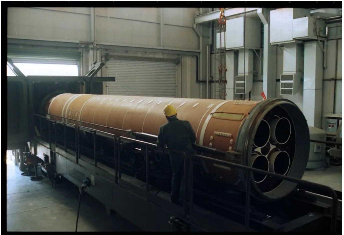
Missile S3 dans l'AVV (atelier assemblage vecteur) avant son installation
