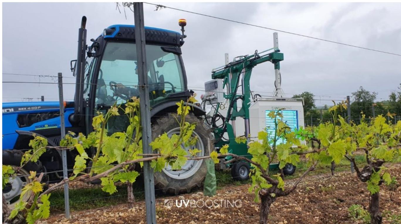
**Des chercheurs de l'Université d'Avignon sont à l'origine d'un dispositif unique protégeant les plantes (vignes et fraises) en les exposant à un rayonnement. [UV Boosting](#) conçoit des équipements de stimulation de défense naturelle des plantes par flashes UV, permettant de réduire les besoins en fongicides.**
