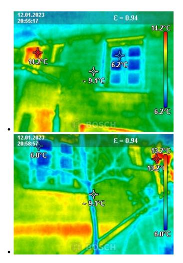
Les caméras thermiques permettent de visualiser les pertes énergétiques  $\ \ \, \mathbb O$  DR J.R.
