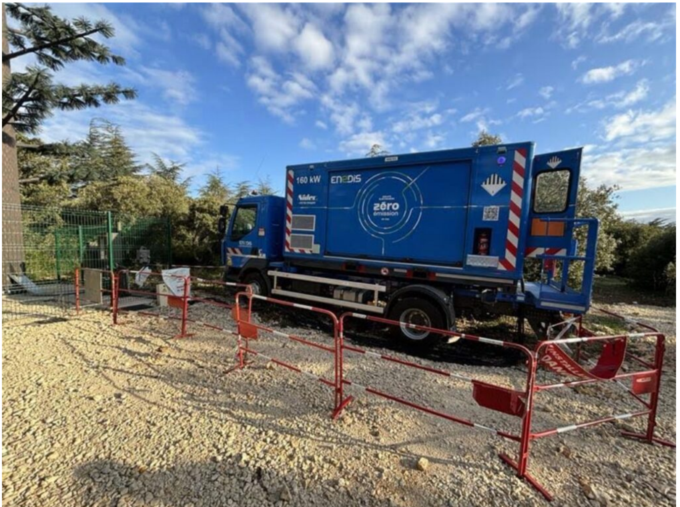
Le groupe électrogène zéro émission. ©Enedis
