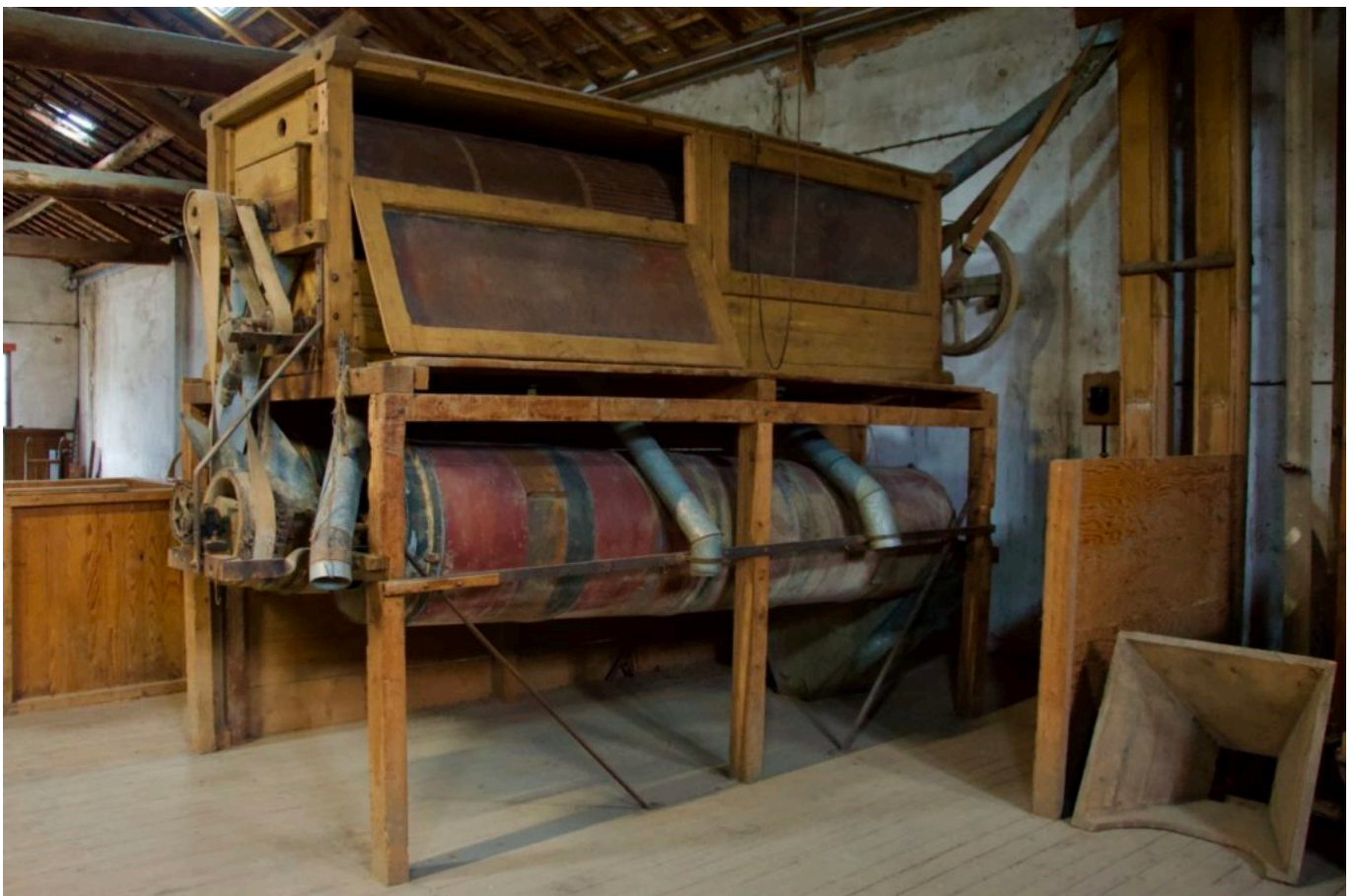
Une des plus anciennes machines de la graineterie Roux. Elle permet de trier les corps étrangers et les graines. ©Vanessa Arnal
