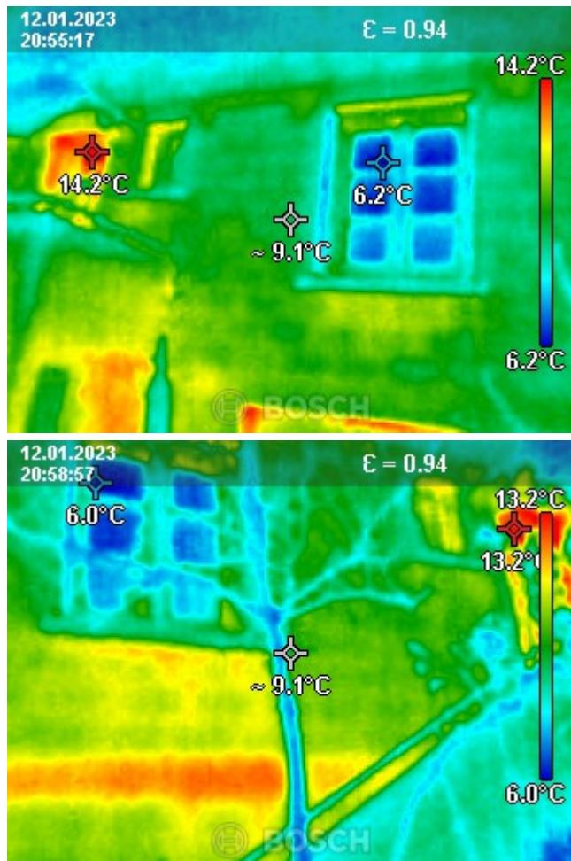
Les caméras thermiques permettent de visualiser les pertes énergétiques © DR
