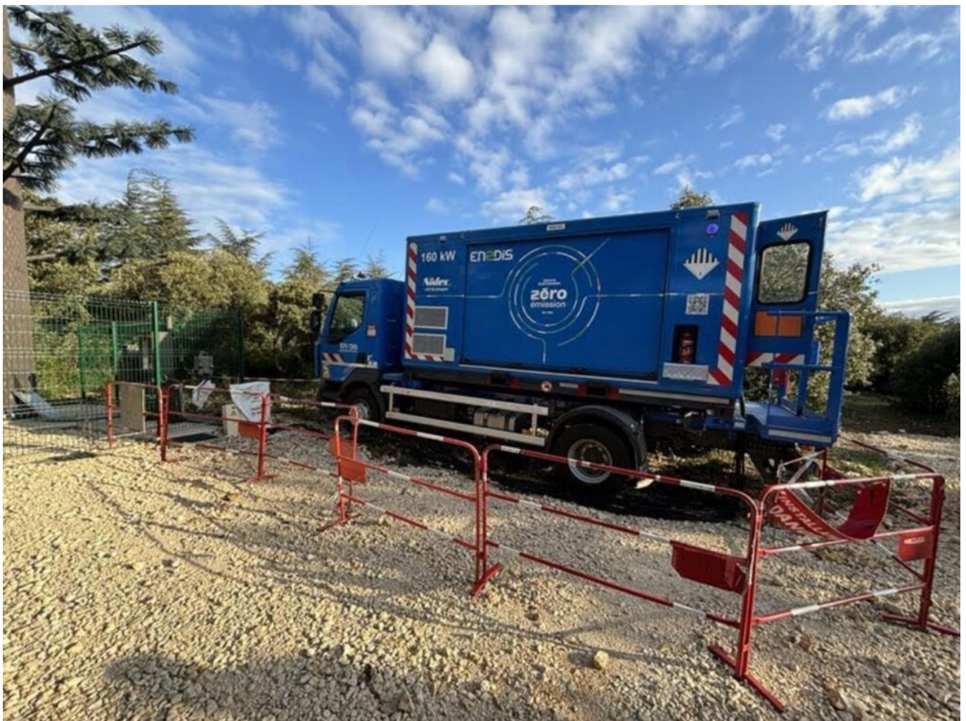
Le groupe électrogène zéro émission. ©Enedis
