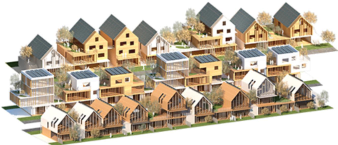
Tous les éléments internes des habitations sont semblables, seuls les façades et volumes varient à partir d'un même système modulaire. Les structures et les façades à ossature bois sont préfabriquées en atelier en matériaux biosourcés.
