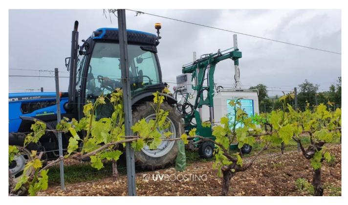
Des chercheurs de l'Université d'Avignon sont à l'origine d'un dispositif unique protégeant les plantes (vignes et fraises) en les exposant à un rayonnement. <u>UV Boosting</u> conçoit des équipements de stimulation de défense naturelle des plantes par flashs UV, permettant de réduire les besoins en fongicides.
