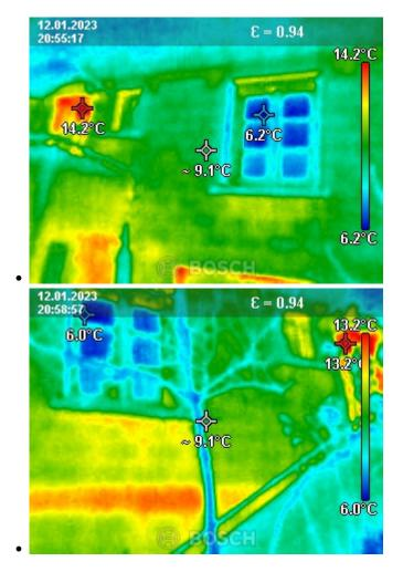
Les caméras thermiques permettent de visualiser les pertes énergétiques  $\ \ \,$  DR J.R.
