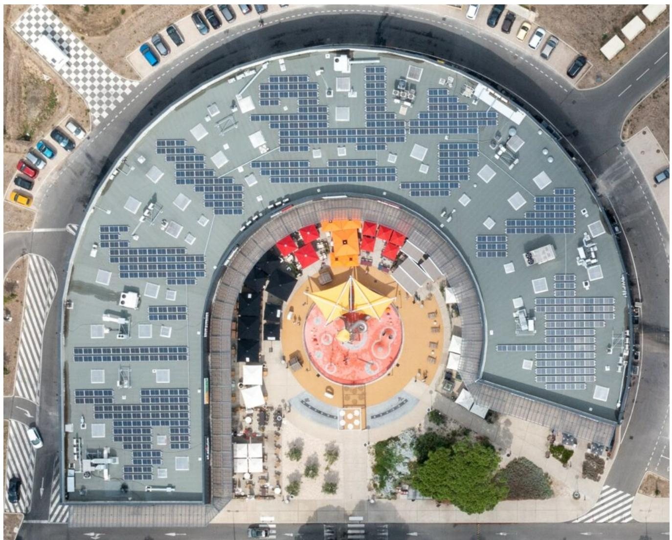
Les toits [des Terrasses des saveurs](#) sont désormais équipés de plus de 4 000m<sup>2</sup> panneaux photovoltaïques délivrant une puissance installée de 172kWc. Grâce à ces 500 modules solaires implantés sur ce pôle restauration multi-enseignes de 4 000m<sup>2</sup> inauguré au printemps 2019 abritant 10
