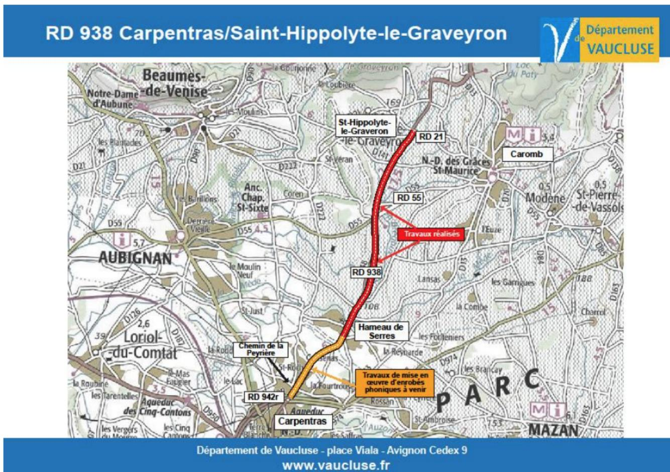
Du lundi 9 au vendredi 13 mai prochains, la RD938 va faire l'objet de travaux. La section comprise entre le Sud du hameau de Serres et la déviation Nord de Carpentras va se revêtir d'enrobés phoniques qui auront pour objectif d'atténuer le bruit de roulement des véhicules sur environ 1 700 mètres linéaires.
