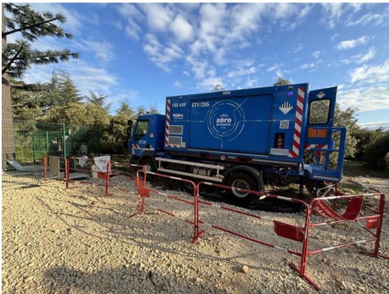
Le groupe électrogène zéro émission. ©Enedis
