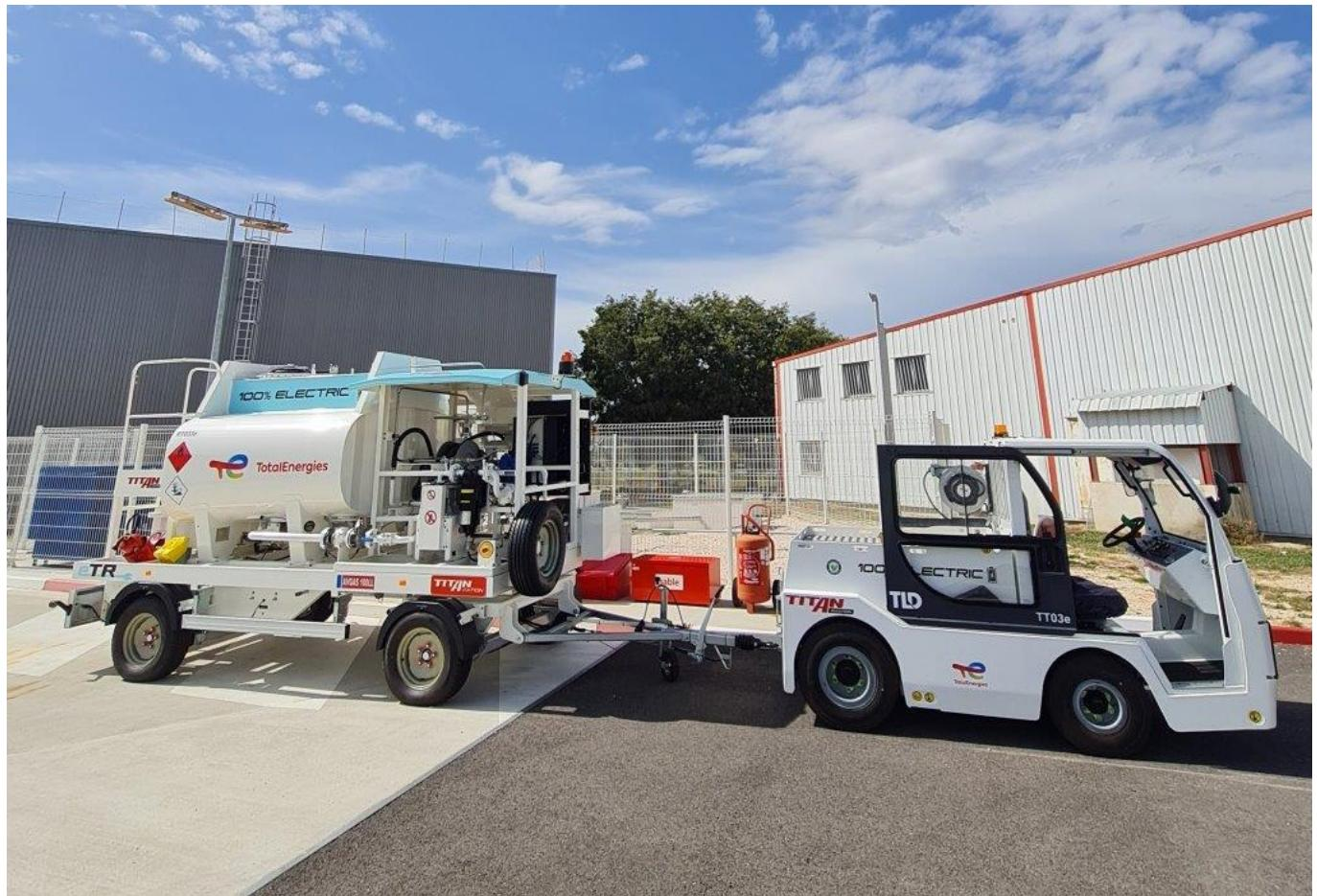
L'aéroport d'Avignon-Provence dispose désormais de nouveau camion-citerne ravitailleur 100% électrique. Ce véhicule mis en place en partenariat avec Total Energies, son fournisseur de carburant, doit permettre à la plate-forme aéroportuaire vauclusienne de réduire ses émissions carbone de 4,5 Teq (Toxic equivalent quantity ou quantité équivalente toxique) sur un an.
