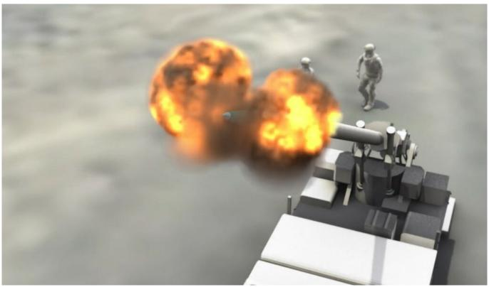
La connaissance de la capacité d'allumage de l'ensemble des grains de poudre permet de maîtriser la montée en pression et propulser un obus à une quarantaine de kilomètres comme c'est le cas avec les canons Casear de Nexter. © Eurenco
