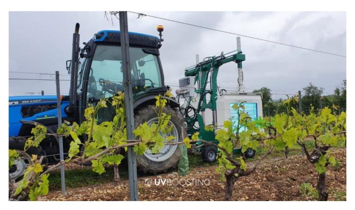
Des chercheurs de l'Université d'Avignon sont à l'origine d'un dispositif unique protégeant les plantes (vignes et fraises) en les exposant à un rayonnement. <u>UV Boosting</u> conçoit des équipements de stimulation de défense naturelle des plantes par flashs UV, permettant de réduire les besoins en fongicides.
