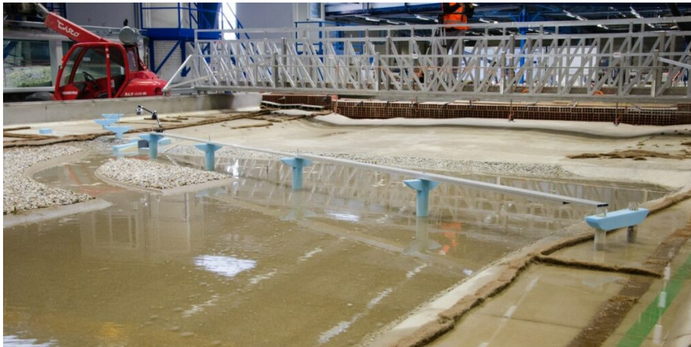
Vue générale du modèle physique du viaduc de la tranche 2. Crédit DREAL PACA
