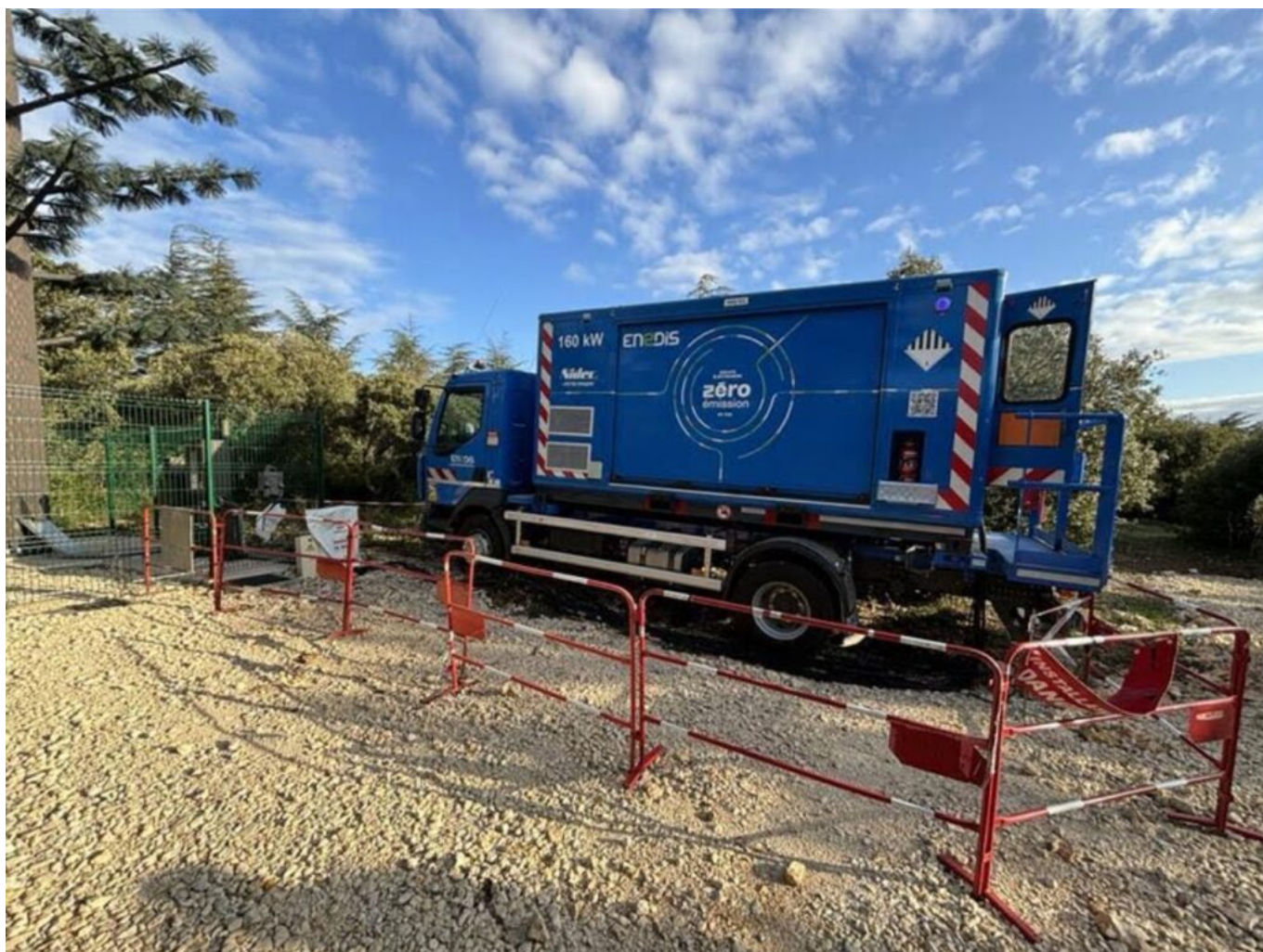
Le groupe électrogène zéro émission. ©Enedis
