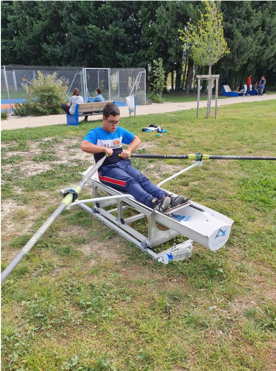
Prototype de bateau solo développé par l'entreprise ATG Technologies © Aviron en Vaucluse
