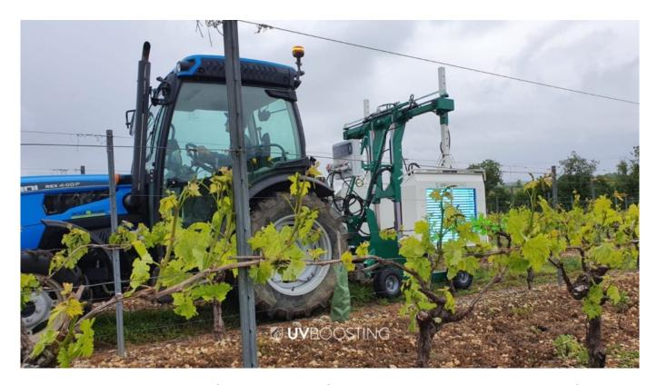
Des chercheurs de l'Université d'Avignon sont à l'origine d'un dispositif unique protégeant les plantes (vignes et fraises) en les exposant à un rayonnement. UV Boosting conçoit des équipements de stimulation de défense naturelle des plantes par flashs UV, permettant de réduire les besoins en fongicides.
