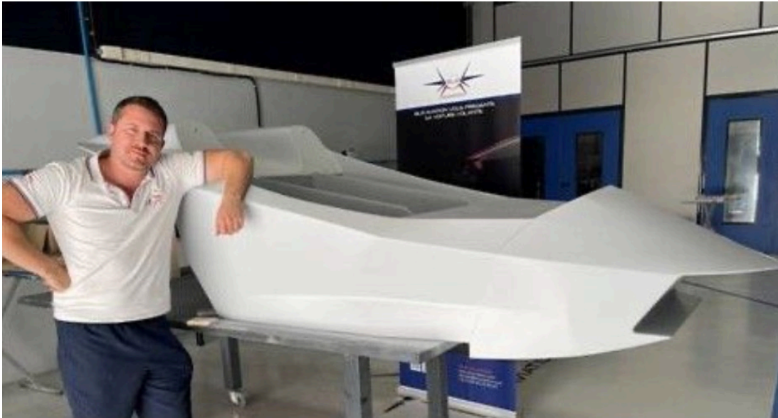
Le moule du châssis. ©BLR Aviation
