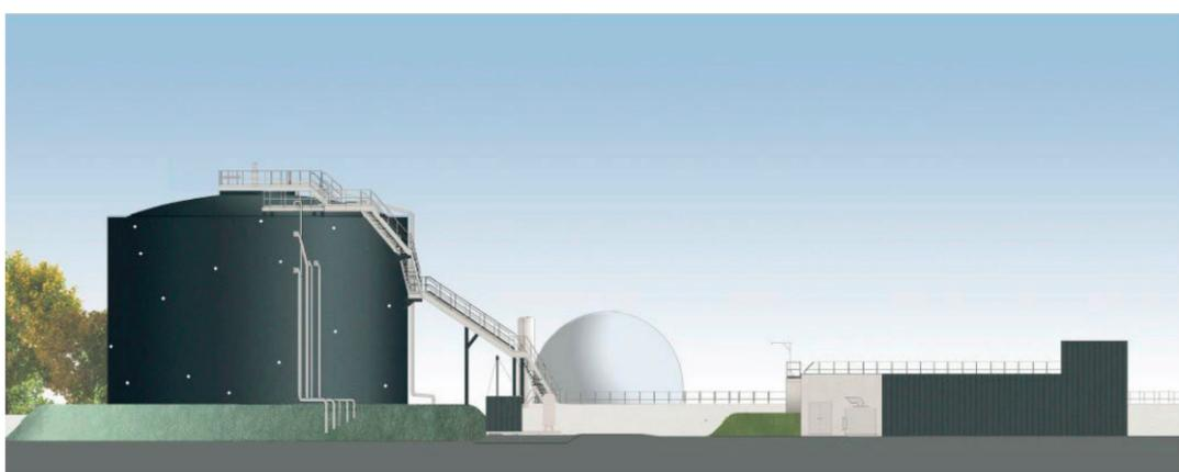
La future unité de méthanisation d'Avignon doit permettre la réduction du volume des boues, la valorisation du biogaz issu des boues en bio-méthane ainsi que la récupération des calories des eaux usées pour chauffer l'unité de digestion permettant la production du gaz.
